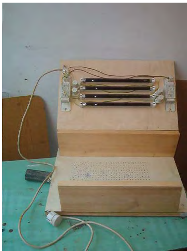
Klisé levilágító. A felső lapot két zsanér tartja, az alsó lap egy légmentes lapos láda, teteje 2 mm-es fűrészárral átluggatva. A kivezető csőhőzkapcsolt porszívó biztosítja a fólia letapadását.
