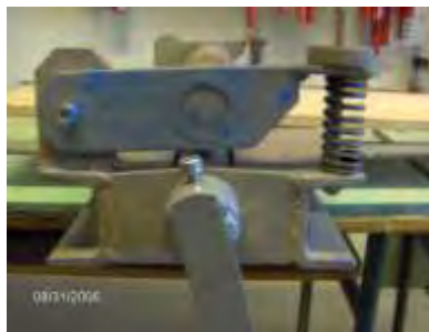
Második kisgépünkél megfordítottuk a mozgó karokat, így alulrugózott gépet kaptunk.
