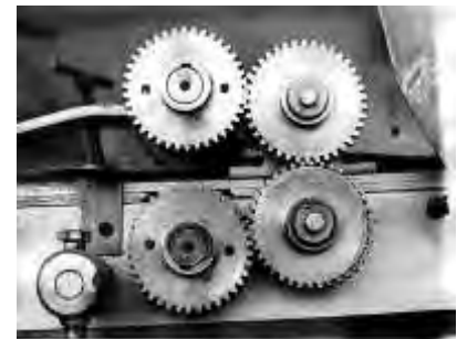
Nagy gépünkön (100 x 140 cm-es futólap) a két hengert a túloldalon összekötöttük egy fogaskerékrendszerrel, ezzel csökkent az elcsúszás veszélye.
