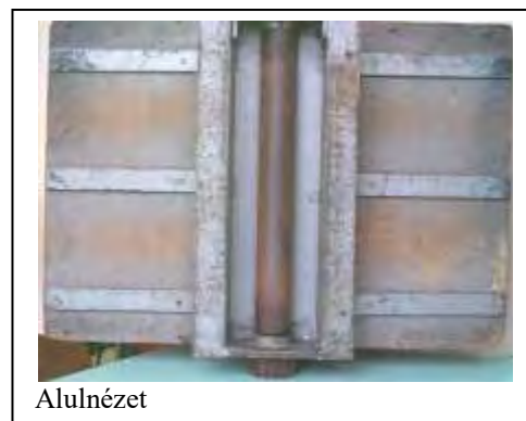
Nagy gépünkön (100 x 140 cm-es futólap) a két hengert a túloldalon összekötöttük egy fogaskerékrendszerrel, ezzel csökkent az elcsúszás veszélye.
