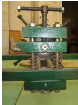
Szellemes megoldású hengerfelfüggesztés a bajai Udvardi vizuból.
