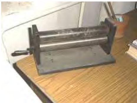
13. ábra A mángorló mintájára készült gép. Hogy a futólap ne lebegjen a levegőben, az alsó henger magasságában oda kell tennünk egy-egy alátét dobozt. Egy Waldorf iskolában fényképeztem.
