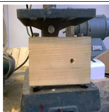
A fúrógép asztalát stabilizáló eszköz.
