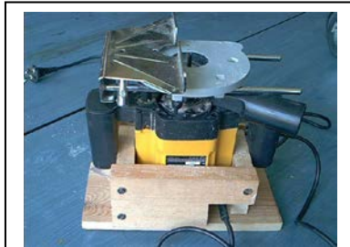
Felsőmarónkat egy faládába tettük, ezt pillanatszorítókkal az asztalhoz
