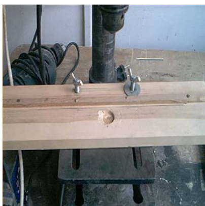
A marásokhoz beállító sablonként szolgáló szerkezet
