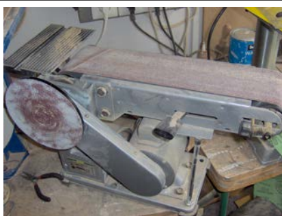
Szalag-körcsiszoló. Üveglapok széleinek, illetve finomabb fa munkadarabok csiszolásához.
